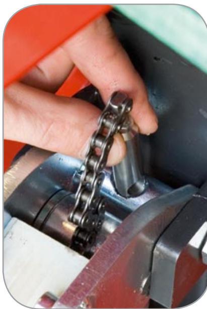
Enkelt demontert håndtak for å lette transporten
